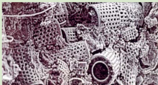
10d porenreiche Gehäuse der Kieselalge Melosira aus Siliziumdioxid in der Asche von Diatomeenkohle
